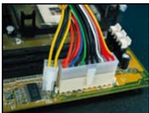
主機板使用 20-pin 電源輸入
