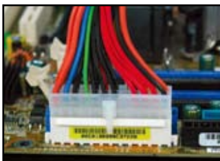
主機板使用 24-pin 電源輸入
