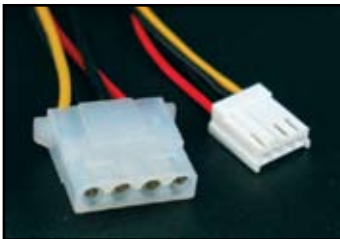
Stromanschluss für Peripherie (links) Disketten Stromanschluss (rechts)
